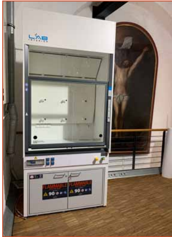
Noch nicht angeschlossen, aber fertig zusammengebaut: der Lösungsmittelabzug. Foto: Fridericke Conrad
